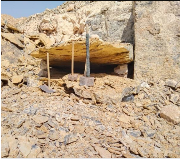
شكل (4) صور توضح المقراف والأدوات التقليدية المستخدمة في استخراجه. [الباحث]
