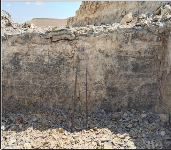
شكل (4) صور توضح المقراف والأدوات التقليدية المستخدمة في استخراجه. [الباحث]
