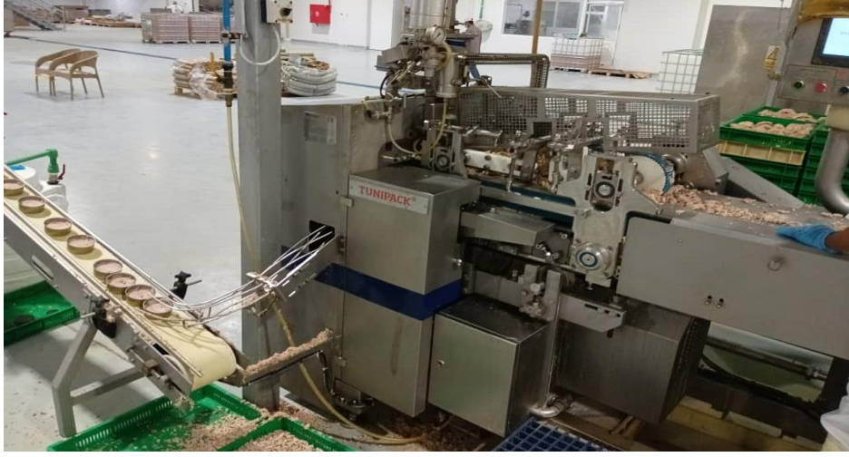
صورة ( 3 ) السيور الناقلة لنقل علب التونة للتعبئة
